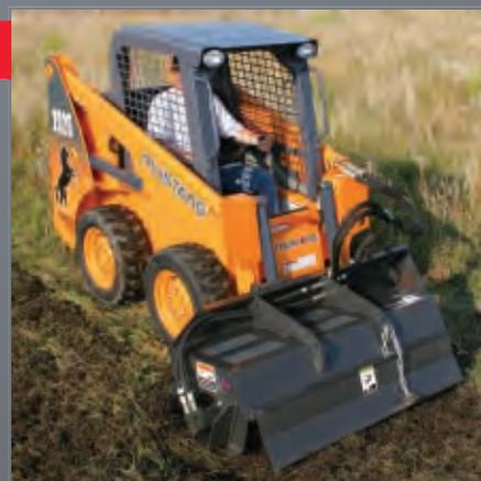
**UN ENGIN MULTITACHES ▲** compatible avec un grand nombre d'accessoires qui peuvent être alimentés par le système hydraulique auxiliaire.
