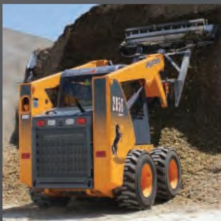
**LE SYSTÈME DE FIXATION HYDRAULIQUE POWER-A-TACH® ▲** proposé en option permet à l'opérateur de changer de benne et d'accessoires sans quitter son siège.
