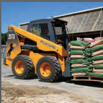
**UN COUPLE DE DÉMARRAGE ÉLEVÉ ▲** pour une accélération rapide avec ou sans charge, grâce aux moteurs à piston radial.
