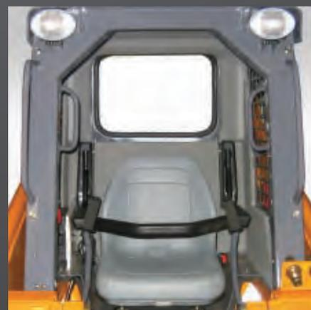
**UN GARDE-CORPS LATÉRAL UNIQUE ▲** qui se fixe sur le système de sécurité Hydraloc™, garantissant ainsi la sécurité de l'opérateur en empêchant le démarrage du moteur lorsque celui-ci ne se trouve pas sur le siège avec le garde-corps en place.
