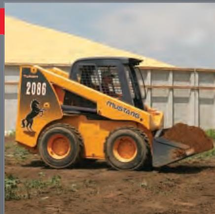
**LA COMMANDE DE ROULEMENT HYDRAGLIDE™ ▲** de série (et avec configurations) permet à la benne de "flotter" en position de transport, réduisant ainsi la quantité de déversement de matériau.
