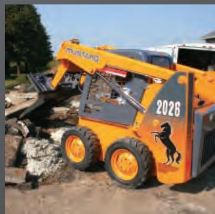
**PLUS DE PROTECTION ▲** grâce à la structure robuste ROPS/FOPS certifiée de niveau II. Les opérateurs bénéficient également d'une vue panoramique dégagée sur l'accessoire et les zones de travail environnantes.
