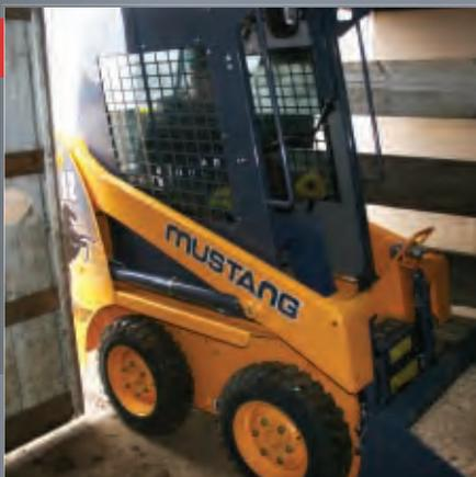
**UNE LARGEUR RÉDUITE** ▲ de seulement 914 mm avec un train de pneus à chevrons de 5,70 x 12, et de 1 118 mm avec un train de pneus de 8,50 x 12 HD, qui permet à la chargeuse 2012 d'aller là où les autres engins ne vont pas.
