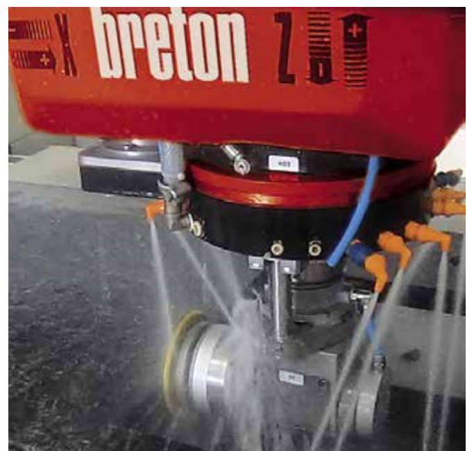
Zubehör zum Aussägen von rechteckigen Ausschnitten (mit Sägeblatt) und zum Polieren von geraden Innenkanten (mit Tellern). Kit pour réaliser l'évidage de lavabo à arête vive à 90° avec chant interne poli
