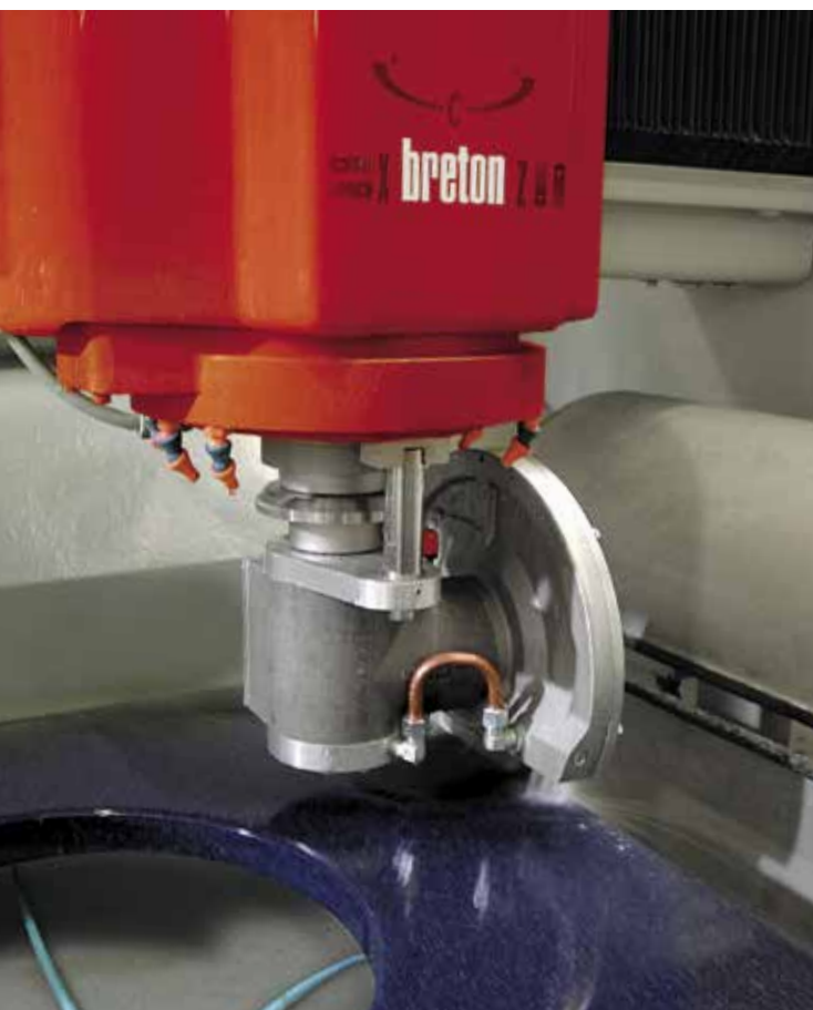
Schneideinheit mit vertikalem Sägeblatt für gerade Schnitte Unité de coupe à disque vertical pour coupes rectilignes
