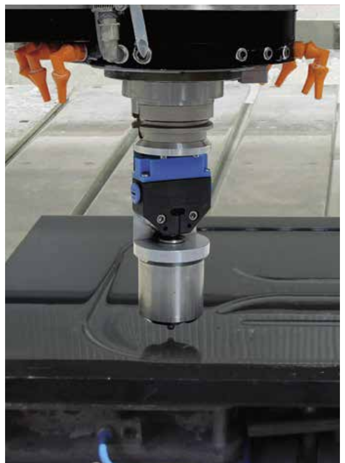
Vermessung der Materialstärke, um mit der polierten Werkstückoberfläche nach oben zu arbeiten Mesure de l'épaisseur du matériau pour travailler avec la face polie vers le haut
