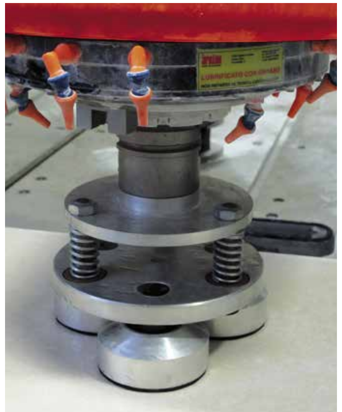
Vielzweck-Kopf für verschiedene Bearbeitungen Tête polyvalente pour différents types de finitions
