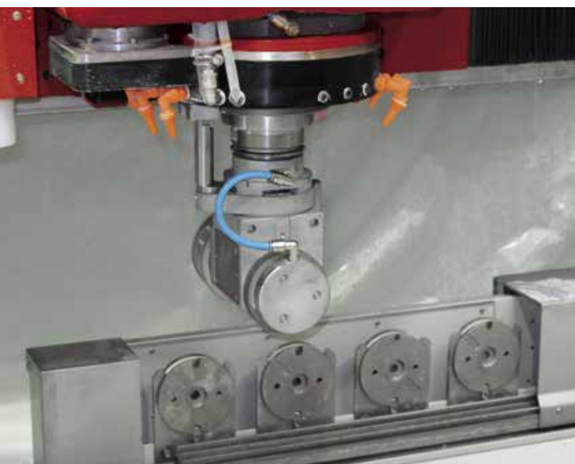
Zubehör zum Aussägen von rechteckigen Ausschnitten (mit Sägeblatt) und zum Polieren von geraden Innenkanten (mit Tellern). Kit pour réaliser l'évidage de lavabo à arête vive à 90° avec chant interne poli
