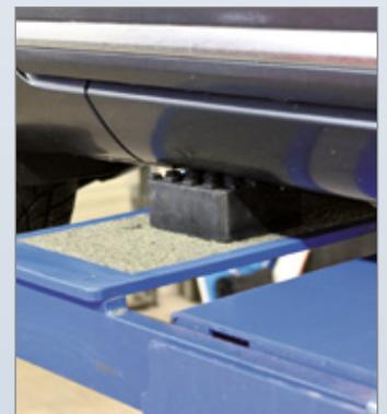
Le revêtement granulé en série des plateaux et extensions garantit un passage du véhicule sans glissement même dans conditions mouillées ainsi qu'un levage en toute sécurité avec des blocs de fixation.
