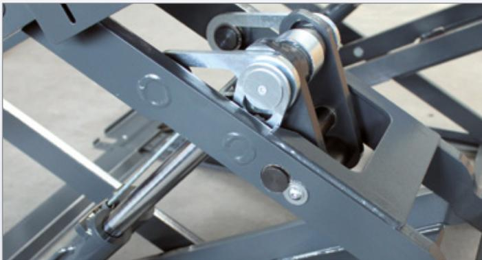
Système de levage assisté innovant des vérins : pleine puissance de levage même à une faible hauteur. Lors du processus d'abaissement, l'élévateur à nacelle à vitesse différée et silencieuse se déplace dans la position la plus basse, elle élève également la partie la plus basse et ne heurte pas le véhicule. Le système de levage assisté des vérins exécute seulement un mouvement de déroulement. Il ne requiert pas d'entretien et ne s'use pratiquement pas.
