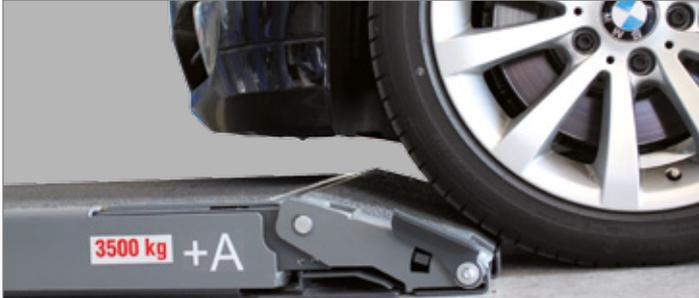
TWIN F IV 3.0/3.5 A : Faible hauteur de passage 105 mm
