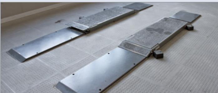
4 rampes d'accès pour les véhicules au châssis surbaissé (option), d'une hauteur de 40 mm ...
