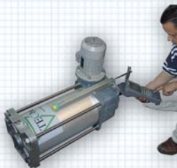
Unité de test pour turbines de centrale électrique
