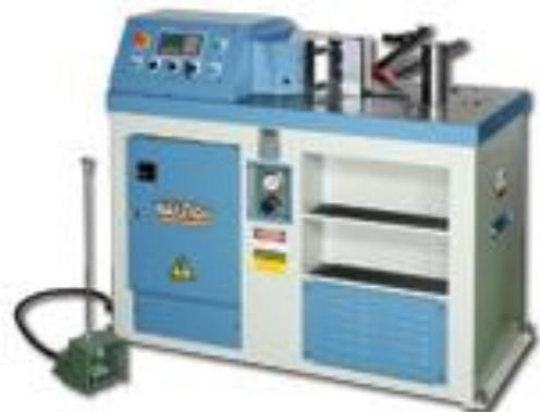
Nos presses plieuses horizontales sont à commande numérique (NC) et peuvent mémoriser jusqu'à 99 programmes avec près de 10 cintrages par programme. Ces modèles sont livrés en standard avec un ensemble d'outillage en V standard, un contrôleur numérique, une butée réglable manuelle, et un régulateur de pression paramétrable.
