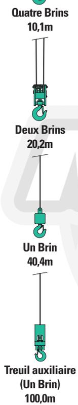
Le diagramme de portée montre la charge nominale totale, déformation de la flèche incluse.
