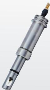
L'H<sub>2</sub> dissous passe à travers la membrane perméable au gaz. Il se diffuse jusqu'à l'électrode de travail où s'opère une réaction d'oxydation électrochimique. Le courant généré, proportionnel à la concentration en H<sub>2</sub>, est mesuré par la sonde.
