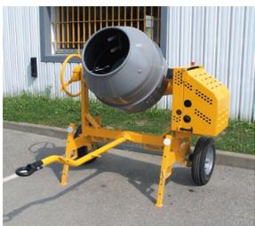
140 litres de capacité de malaxage = 1 gachée de ciment de 35 kg
