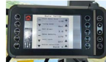
Grâce à l'interface ISOBUS, la presse communique en continu avec les boîtiers de commande embarqués ISOBUS, tels que le terminal Vario Fendt.
