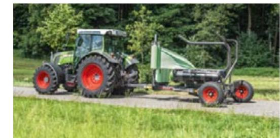
La Fendt Rollector enrubanne des balles de 0,90 m à 1,30 m de diamètre.
