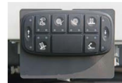
Il est très facile d'utiliser le combiné de pressage-enrubannage grâce au panneau de commande situé à l'arrière de la machine et qui peut donc être commandé.
