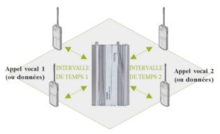
L'intervalle de temps 1 est utilisé pour l'appel vocal 1 L'intervalle de temps 2 est utilisé pour l'appel vocal 2
