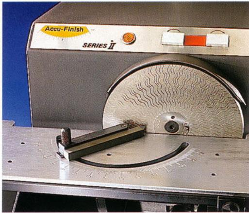
La table de l'Accu-Finish montée sur roulements est réglable pour les angles composés
