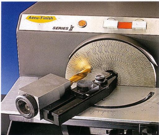
Avec ce montage on obtient facilement un affûtage précis
