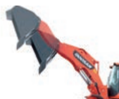
Bras de levage à grande hauteur Plus de portée de déversement et plus de hauteur au pivot de godet
