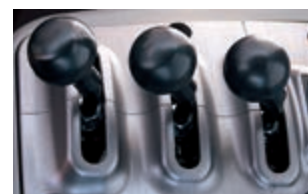
Mini-leviers servocommandés Trois leviers pour commander les bras de levage, le godet et le circuit hydraulique auxiliaire. Contacteurs pour AV/PM/AR, rétrogradage forcé, retour en position d'attaque, arrêt automatique des bras de levage et mode de flottement.
