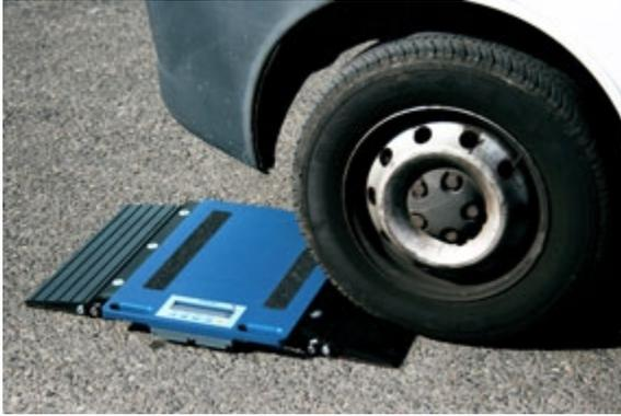
L'exemple montre une application avec 2 rampes WWS-R.
