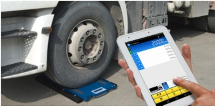
L'exemple vous montre une application avec une WWS. Une WWS RF, option WWSDUAL, option Bluetooth et Tablet avec APP gratuite Dini Smart AXLE, qui peut être téléchargé par Playstore à partir du lien suivant :
