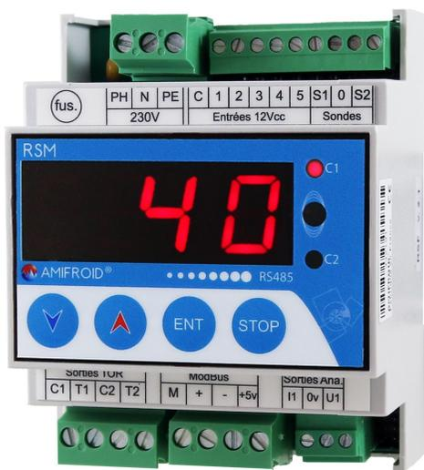
Ce régulateur standard avec sorties multifonctions est destiné à la régulation de valeurs telles que Température, Hygrométrie, Pression ou valeurs analogiques 4-20mA ou 0-10V. En fonction du type de régulation, le module peut réguler deux sorties relais TOR et une sortie analogique 4-20mA ou 0-10V
