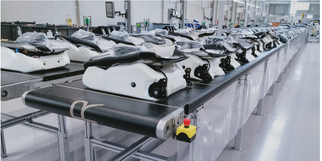
GUF-P 2004 d'une longueur de 45 mètres en tant que ligne d'approvisionnement dans la production « Just-in-Sequence » de sièges de voiture
