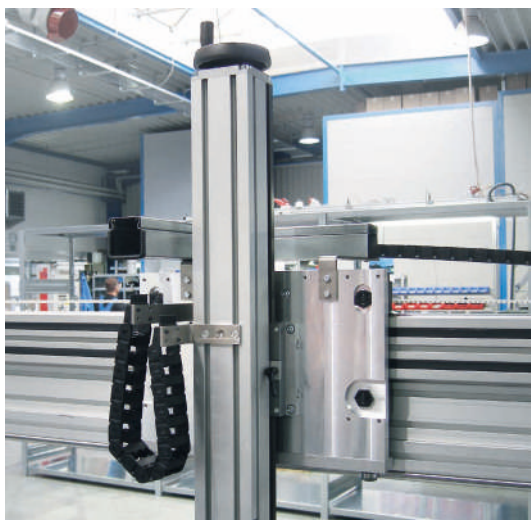
Base LZR 2005-38.44-30 avec chariot de roulement latéral sur profilé combiné avec revêtement en mousse en tant que portique, avec rouleaux d'appui pouvant supporter des charges dans toutes les directions et VST 2011 manuel en tant qu'axe Z
