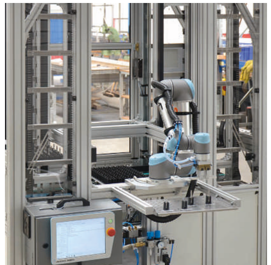
Cellule de production avec réserve double pater noster pour pièces acheminées et évacuées
