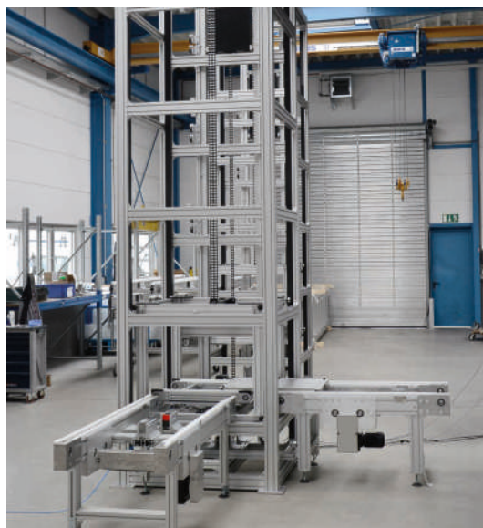
Élévateur accessible de trois côtés, avec couronne rotative dans la nacelle mobile et approvisionnement via Versamove ultra
