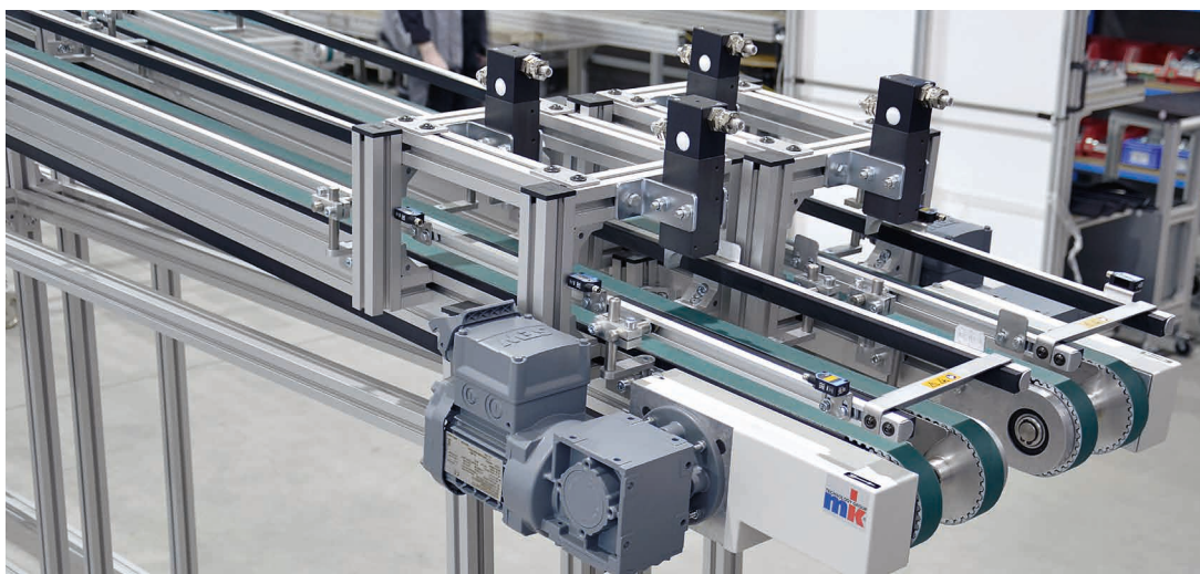
Convoyeur à courroie dentée à deux voies ZRF-P 2040 avec unité de séparation et inclinaison réglable
