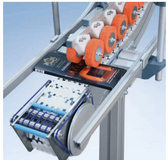
Conveyeur à chaînes charnières SBF A08 avec renvoi de transfert motorisé et rouleaux presseurs pour le transport vertical
