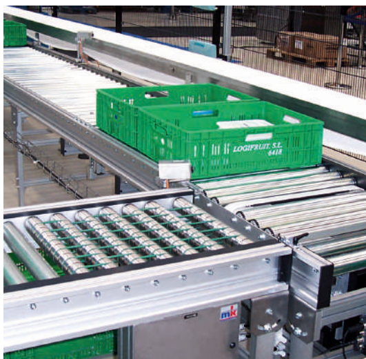
Combinaison de bande transporteuse RBT-P 2255 avec convoyeur de levage transversal
