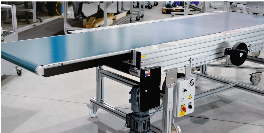
GUF-P 2041 en tant que convoyeur à bande télescopique via réglage manuel avec volant sur montants mobiles
