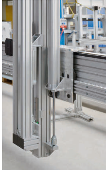
Axe horizontal avec profilé combiné revêtu de mousse pour renforcer la rigidité
