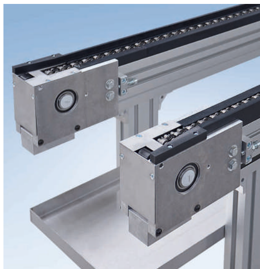
Convoieur d'accumulation à rouleaux SRF-P 2010 avec bac d'égouttage
