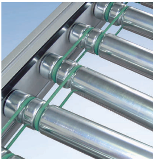
Sur le convoyeur à rouleaux motorisés RBM-P 2255, un rouleau motorisé entraîne jusqu'à neuf autres rouleaux
