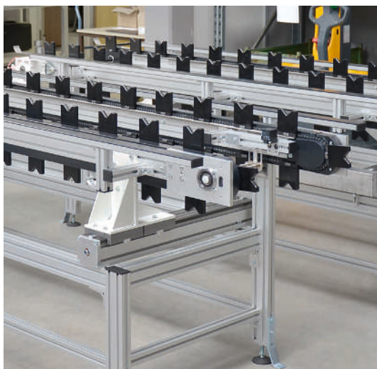
TKU 2040 avec unité de réglage spécifique pour le réglage de l'écart des lignes de transport entre elles
