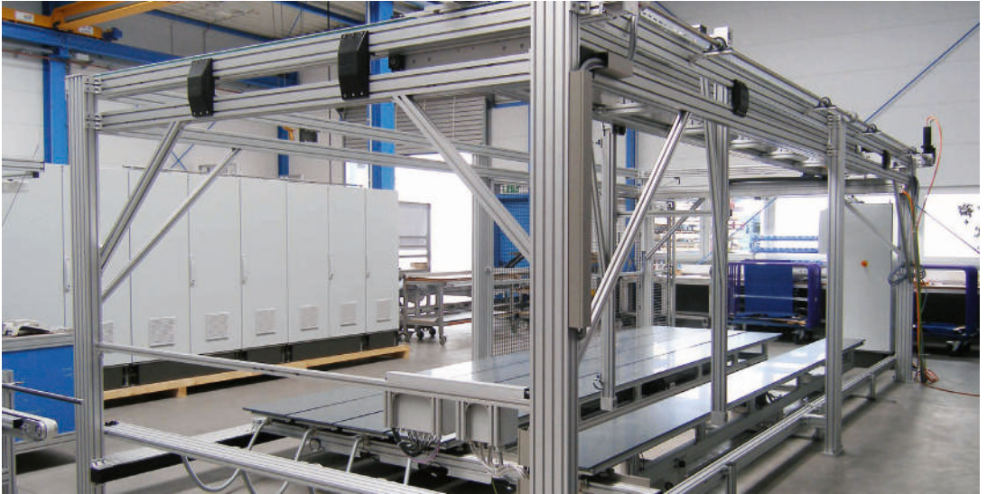
Portique de manipulation X-Y-Z pour la surveillance régulière de la croissance de plantes
