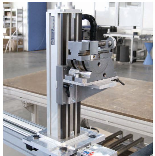
VST 2011 à moteur électrique avec système de mesure propre au client sur LZR 2005-38.44-30
