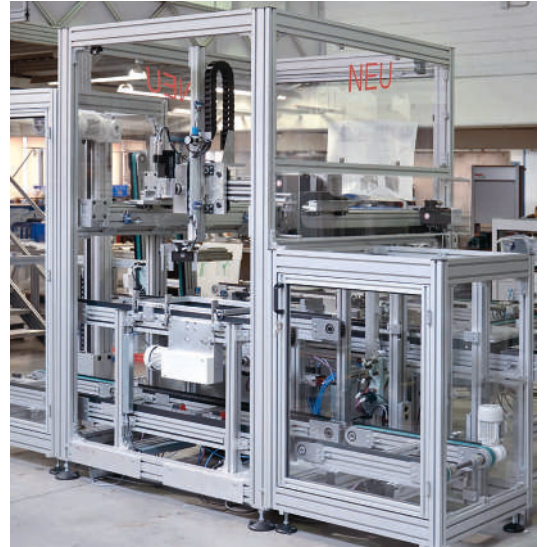
Circulation des porte-pièces pour différents niveaux de transport avec portique à 3 axes
