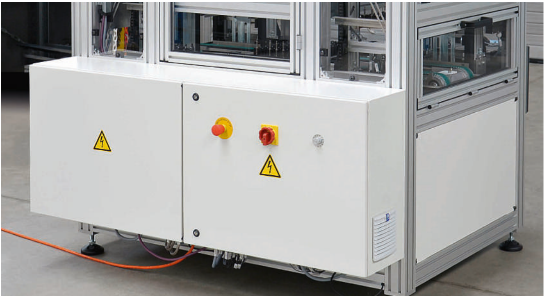
Armoire de commande montée sur la combinaison de dispositif de protection et du bâti
