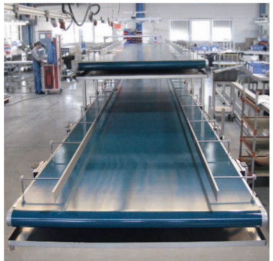
GUF-P 2004 avec entraînement en tête AS, latéral, à l'extérieur, en tant que convoyeur à 2 niveaux avec bacs d'égouttage sur un bâti de base commun
