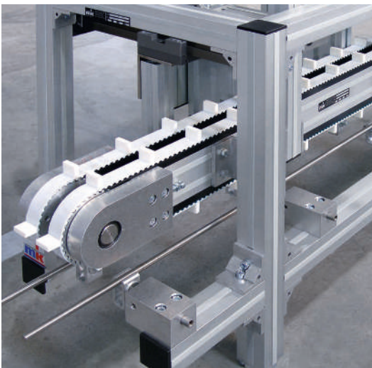
Double convoyeur à courroie dentée à largeur variable avec tasseaux
