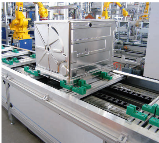
SPU double voie en tant que bande d'alimentation pour carter de lave-vaisselle
