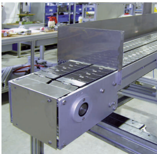
Convoyeur à chaînes charnières à double voie avec moteur
