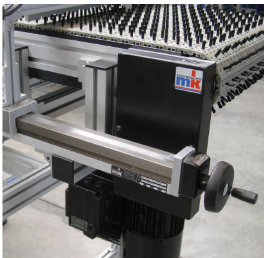
VST 2015 double avec affichage numérique manuel pour le réglage de la barre de butée
