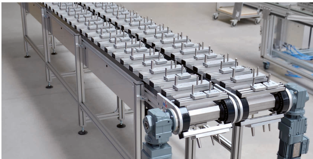
TKU en tant que système deux voies avec porte-pièces et logements en profilés conçus pour une commande spécifique
