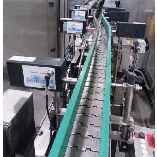
Convoyeur en acier inoxydable Versaflex SBF avec guidage latéral réglable automatique ASTRRA
