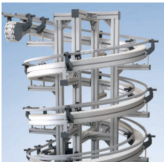
Versaflex SBF A08 en tant que convoyeur hélicoïdal
