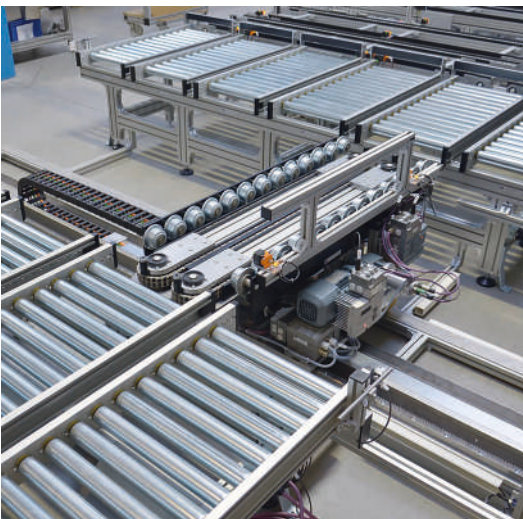
Convoyeurs à rouleaux RBT-P 2255 en tant que convoyeur à rouleaux avec chargement et déchargement
