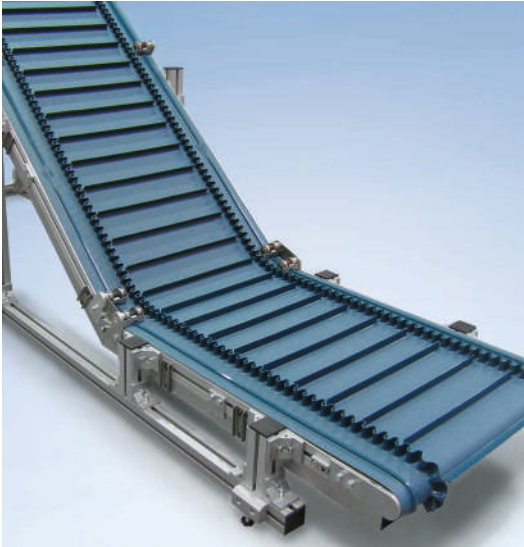
Convoyeur col de cygne à bande KFG-P 2000 avec bord de contenance pour la limitation latérale et tasseaux transversaux
