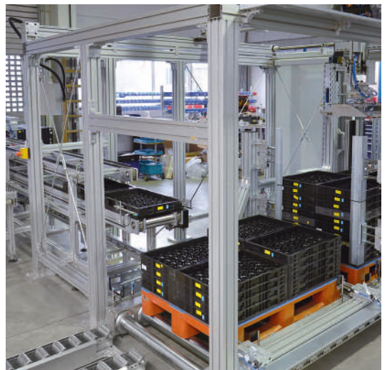
Portique de manipulation X-Y-Z pour empiler et déempiler des palettes de produits sur des europalettes
