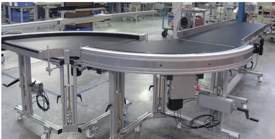
KGF-P 2040 avec entraînement sous-bande BI et réglage de hauteur hydraulique des montants via manivelle
