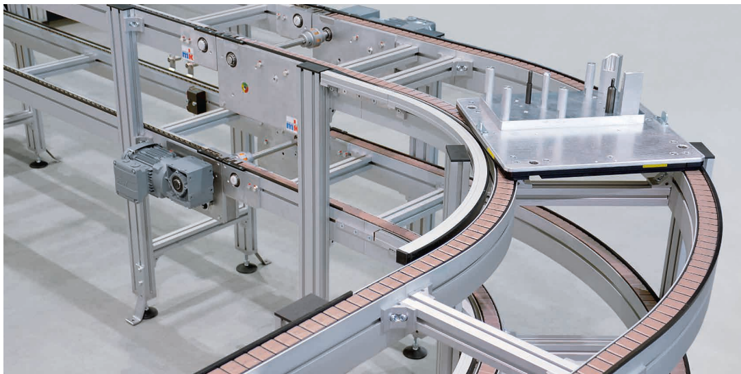
Circuit de porte-pièces Versamove standard avec convoyeur de forme courbe à plaques plates FPF-P 2045 et entraînement des pièces spécifique au client
