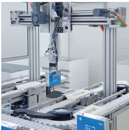
Portique à deux axes avec servomoteurs et préhenseur individuel en combinaison avec convoyeur à chaînes charnières Versaflex
