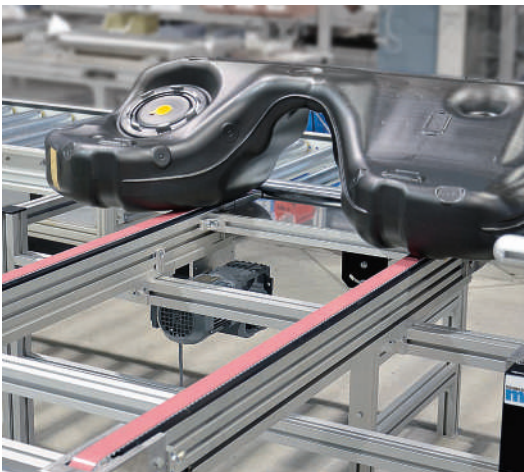
Enchaînement ZRF-P 2010 avec parcours d'évacuation pour réservoirs à carburant
