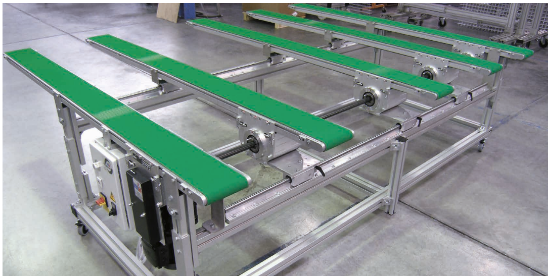
GUF-P MINI avec entraînement sous-bande BC en tant que configuration spécifique avec 5 voies de transport. Les voies de transport intérieures peuvent être décalées manuellement et sont guidées par le biais de tiges de guidage
