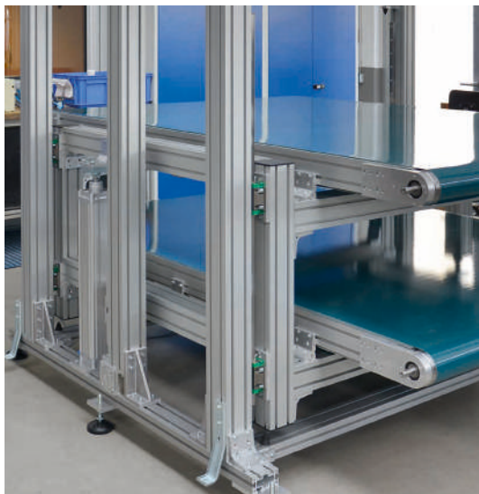
Poste de levage pour lever ou abaisser le convoyeur dans deux niveaux de convoyage. Unité de déplacement latéral avec guidages à recirculation de billes horizontaux dans le bâti
