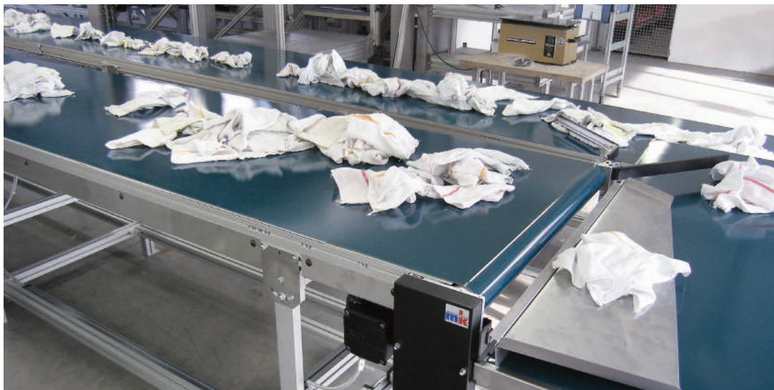
Circuit pour le tri manuel du linge sur la base de GUF-P 2041 et GUF-P 2000 avec entraînement en tête AC
