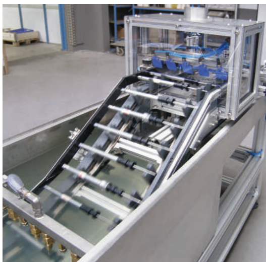
TKU 2040 avec inclinaison à 20° et passage par un bain nettoyant
