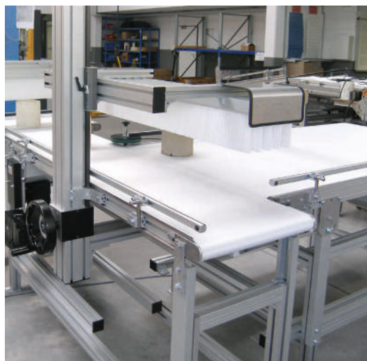
GUF-P 2000 avec unité de réglage intégrée (VST 2011) pour le réglage de la hauteur des brosses du racloir
