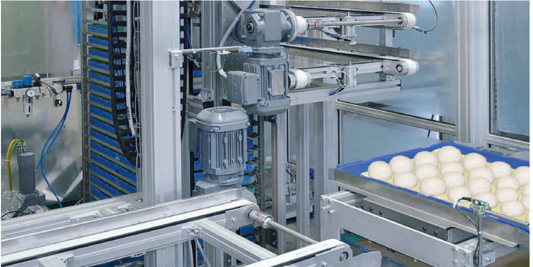
Enchaînement ZRF-P 2010 en tant que station de chargement et de déchargement pour lignes de petits pains avec dispositif d'empilage en tant que tampon
