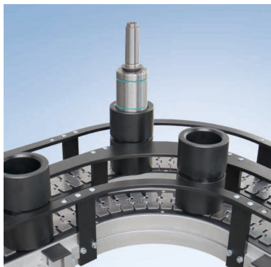
SBF-P 2254 avec courbe 90° glissante et chaîne plate à charnières en acier en tant que mécanisme d'enchaînement pour pièces ondulées
