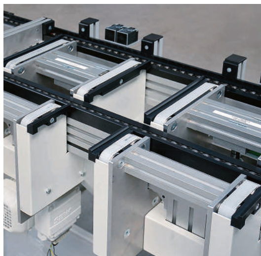
Convoyeur transversal de levage avec entraînement couplé et levage central, pour surmonter des parcours transversaux très courts
