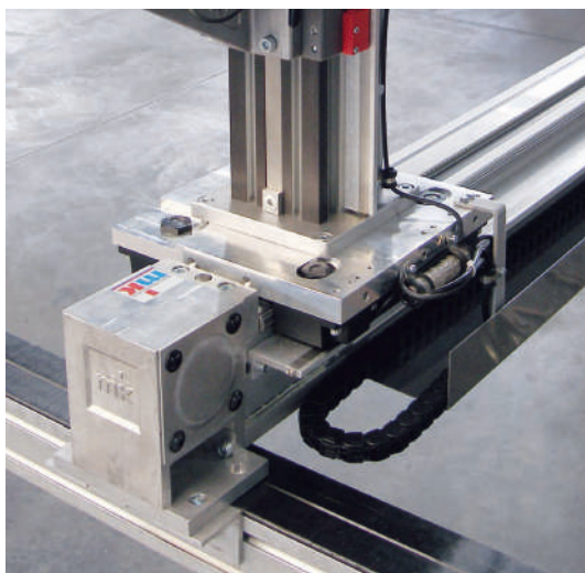
Module linéaire type LZR 2005-38.44-30 en tant que système de mesure de longueurs direct avec tête de mesure sur le chariot de roulement
