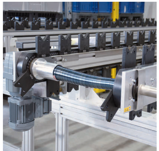
TKU 2040 pour le transport d'arbres à cames avec revêtement en spirale en tant que protection lors des interventions sur l'arbre de transmission
