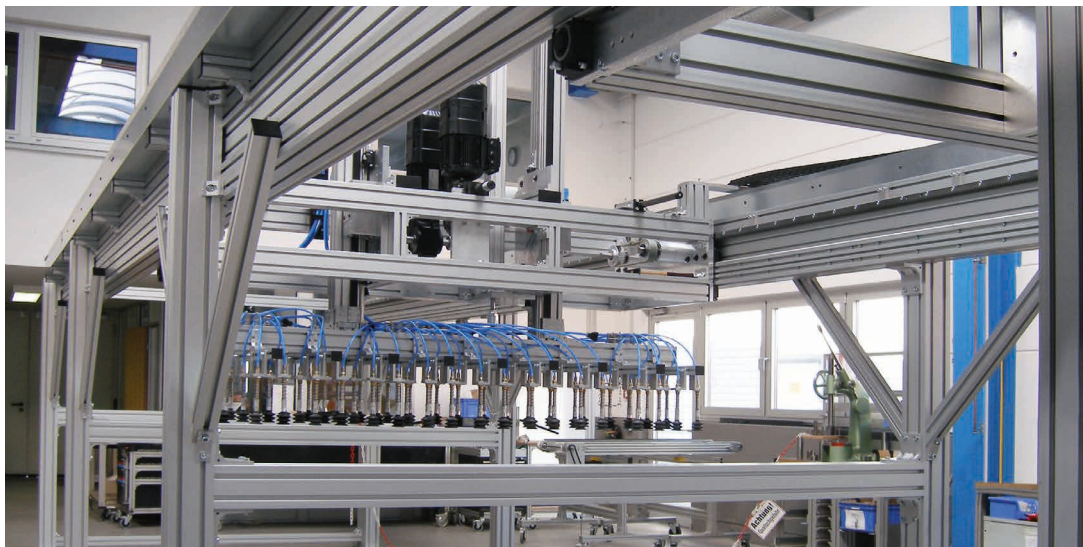
Portique X-Z avec préhenseur par le vide en tant que système de handling et de chargement de tôles d'acier. Deux systèmes de chargement indépendants sur un axe X commun avec crémaillère, avec galets de roulement et entraînement de crémaillère se déplaçant simultanément
