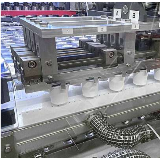
Conveyeur à bande à vide pour un transport rapide et cadencé de gobelets en plastique
