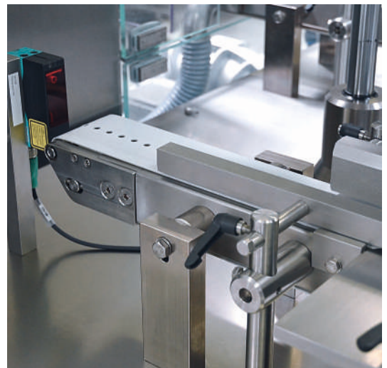
Conveyeur à bande à vide INOX avec guidage latéral individuel
