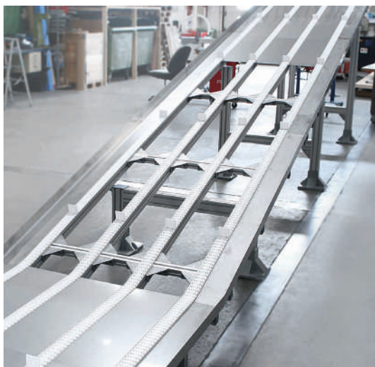
Versaflex à 4 voies SBF A06 avec tablettes intermédiaires et inclinaison
