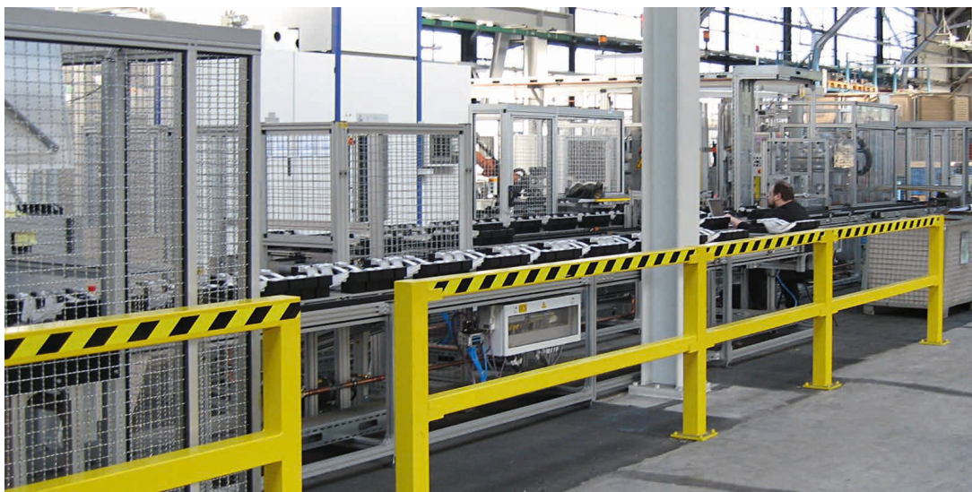
Enchaînement de cellules de production dans le secteur automobile. Approvisionnement manuel des porte-pièces, prélèvement avec manutention et robots. Niveau inférieur pour le retour avec lift et shuttle.
