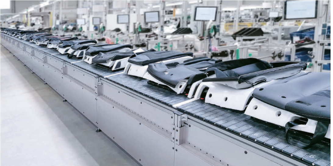
MBF-P 2040 d'une longueur de 42 mètres avec protection latérale anti-reptation et contre le happement pour le montage « Just-in-Sequence » sur la bande en marche
