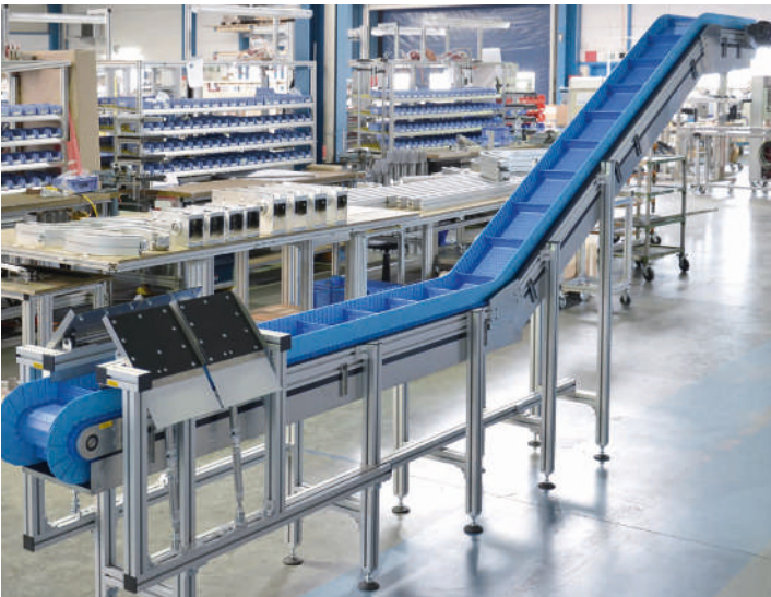
KFM-P 2040 avec bac d'égouttage et capot d'éjection
