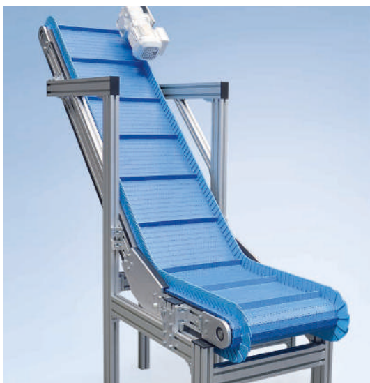
Tapis modulaire de convoyeur col de cygne KFM-P 2040 type L avec entraînement en tête AC et base mobile spécifique au client
