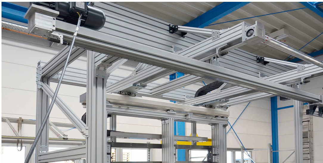
Portique 2 axes pour la manipulation de douilles avec préhenseur parallèle
