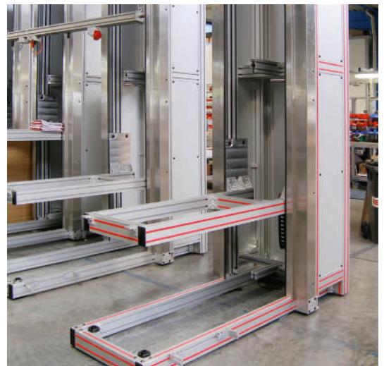
Module linéaire double type LZR 2005-38.44-30 avec potence pour convoyeur et unité élévatrice
