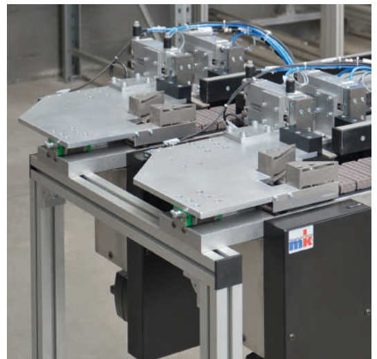
Approvisionnement deux voies pour l'alimentation des machines. Le réglage de la séparation pour différents diamètres a lieu par le biais d'un guidage à recirculation de billes
