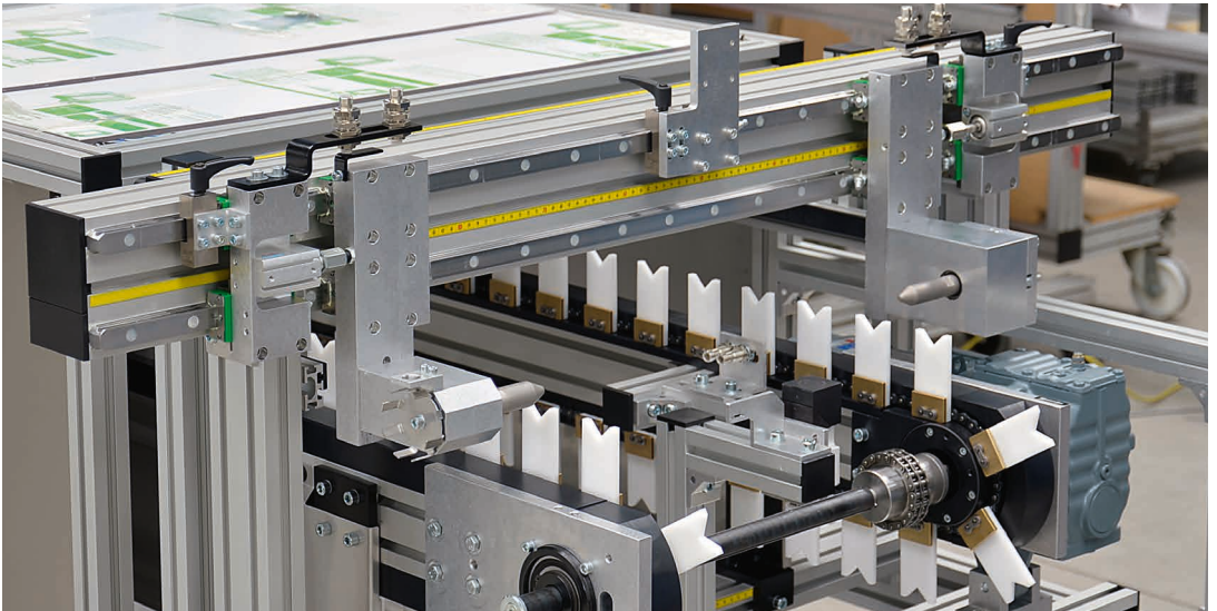
Convoyeur à chaîne cadencé avec unité d'alignement pour arbres à cames via guidage à recirculation de billes
