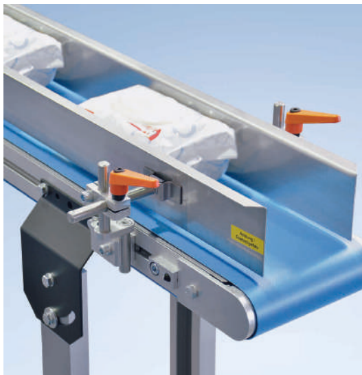
Convoyeur à bande GUF-P 2000 avec renvoi 01 \varnothing 53 et guidage latéral SF02 réglable avec levier de serrage
