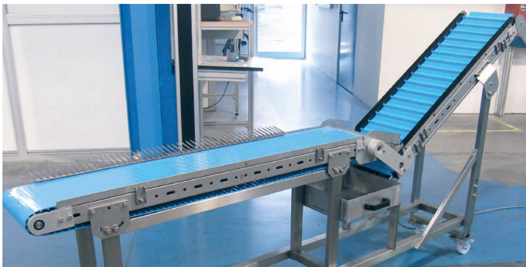
Combinaison de convoyeurs à bande et à bande inclinée INOX pour le transport de boules pralinées avec granulat
