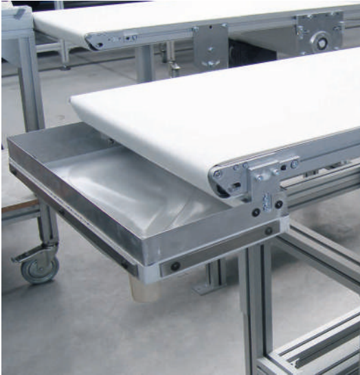
Convoyeur à bande avec sac de récupération des poussières
