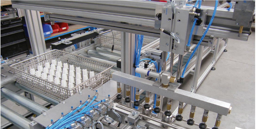
Module linéaire à entraînement pneumatique avec PF 38.77 et LW 38.77-44 en tant qu'unité réductrice avec préhenseur muni de 10 ventouses à vide
