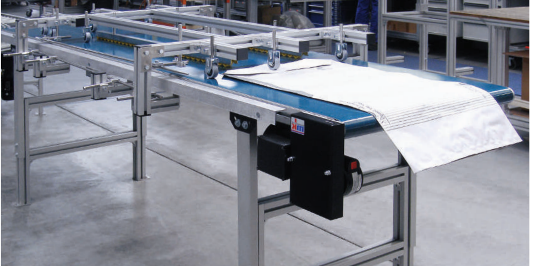
GU-F-P 2000 avec mécanisme pour le pliage et le redressement des sachets en papier avant leur remplissage
