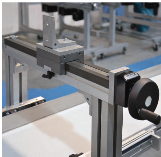
Système de réglage bidimensionnel manuel pour le logement d'un dispositif de marquage avec VST 2015
