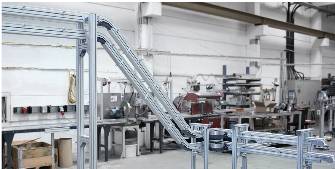
Versaflex SBF A06 avec chaîne plate à charnières et entraîneurs pour le transport vertical
