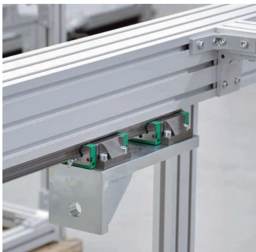
Bâti pour tentatives de col de cygne au moyen du guidage à recirculation de billes KU 30.10
