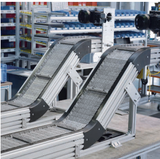
KFS-P 2040.86 entraînement en tête AC avec chaîne perforée de tapis à charnières, tasseaux transversaux et petites bosses pour un meilleur entraînement du produit
