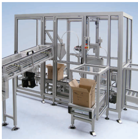
Installation pour le remplissage des cartonnages avec enchaînement du poste de remplissage de tubes en amont et intégration de la balance jointe avec éjection des rejets
