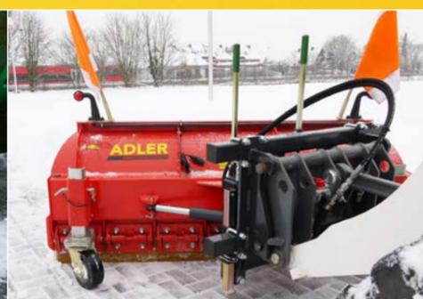
Attelage universel avec rotation hydraulique (avec deux vérins hydrauliques)
