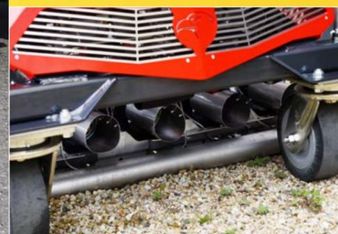
Tampons pare-chocs et rouleaux charge lourde renforcés pour la protection du coffret infrarouge
