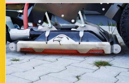
Coffret infrarouge réglable en hauteur pour une adaptation aux chemins et aux surfaces
