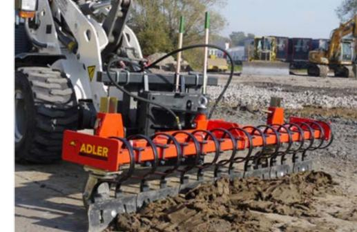
Attelage direct au tracteur ou à la chargeuse sur roues
