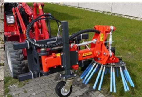
Bras de rotation (mécanique / hydraulique) pour le traitement de grandes surfaces
