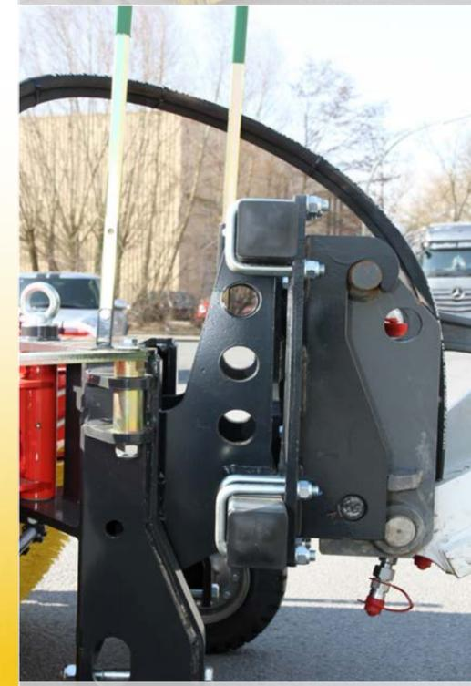
Attelage pour chargeuses sur roues avec guidage de rouleaux et compensation 3D
