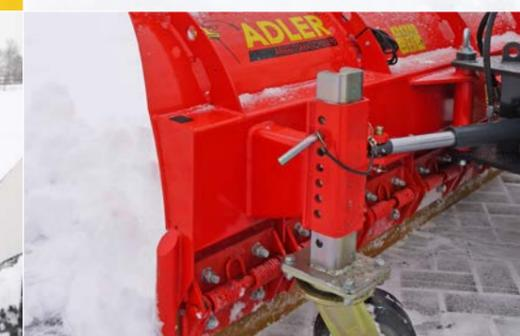
Roues d'appui réglables en hauteur (200 x 80 mm)
