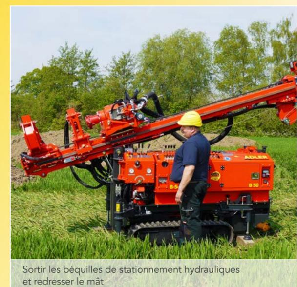
Sortir les béquilles de stationnement hydrauliques et redresser le mât
