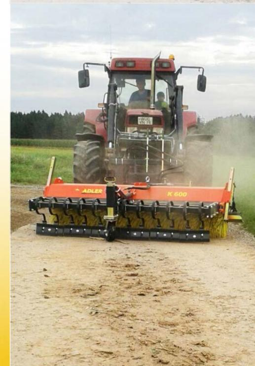
Grattoir série KV avec 3ème roue d'appui
