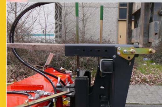
Attelage pour chargeuses sur roues avec guidage à rouleaux et compensation 3D
