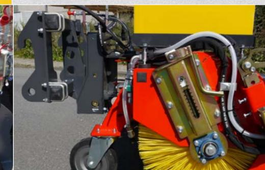
Attelage pour chargeuse sur roues avec compensation de niveau par guidage des rouleaux
