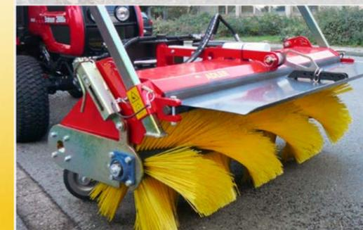
K 560 avec tôle de protection contre les projections d'eau, réglable
