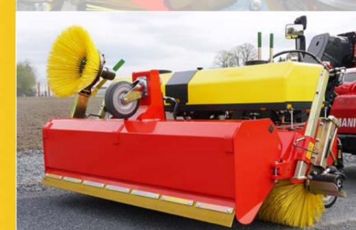
Mode de déblaiement simple, vidage hydraulique et troisième roue d'appui du bac collecteur
