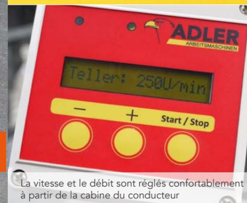
La vitesse et le débit sont réglés confortablement à partir de la cabine du conducteur
