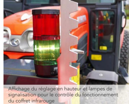
Affichage du réglage en hauteur et lampes de signalisation pour le contrôle du fonctionnement du coffret infrarouge
