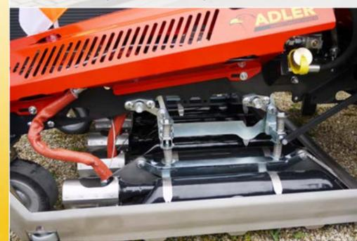
Coffret infrarouge monté sur ressorts et réglable en hauteur par télécommande radio
