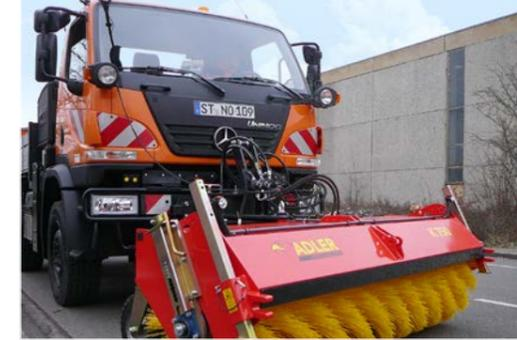
Attelage Unimog avec relevage de l'engin selon DIN 76060
