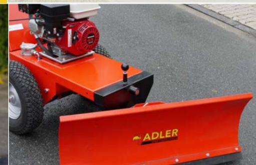
Balayeuse guidée à la main avec lame de déneigement
