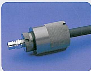
"OD GRIP TIGHT". Obturateur positionné à l'extérieur du tube. Diamètre de DN 1/4" jusqu'à 4". Pression d'épreuve jusqu'à 343 bars.
