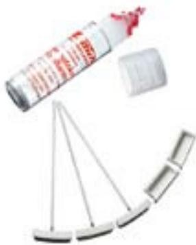
Les différentes coupelles collectrices disposées dans le rotor 2076 peuvent être facilement nettoyées en cas de fuite des tubes capillaires et changées en cas de bris de verre.
