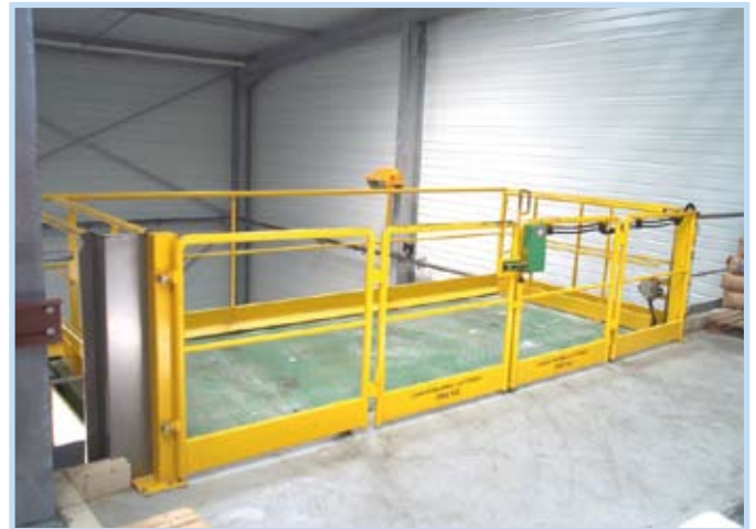
Portillon avec serrure à commande hydraulique
