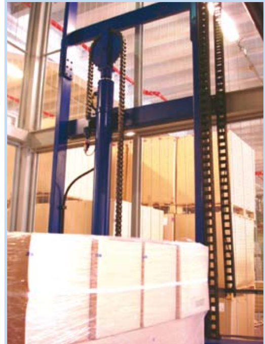
Élévateur charge 2500 Kg plateau 2400 x 2400 mm, course 5500 mm
