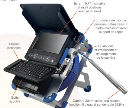
Notre système d'inspection visuelle **AXplorer 23 XSpring HD** tout en un est **ultra portable** et **résistant** grâce à un cadre en aluminium intégrant l'enrouleur de jonc de poussée, sur lequel viennent l'écran et le clavier inclinables.
