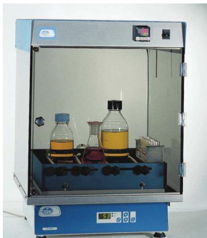
Agitateur orbital / va-et-vient "Rotabit" code 3000974 couplé à la chambre d'incubation "Boxcult".
