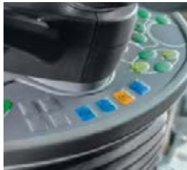
Touches confort pour le verrouillage de l'outil et l'activation de l'amortisseur.
