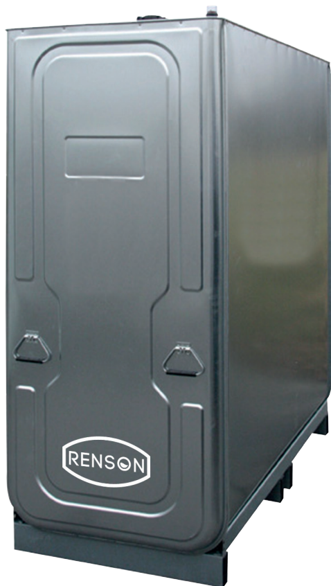
Réservoir 1500 L équipé avec station sur plaque 230 V 56 L/min Filtre à cartouche 6 m de tuyau de refoulement à raccords sertis Pistolet automatique Code 853606
