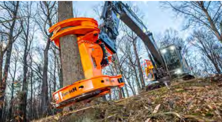
C650 avec un diamètre de coupe allant jusqu'à 70 cm.
