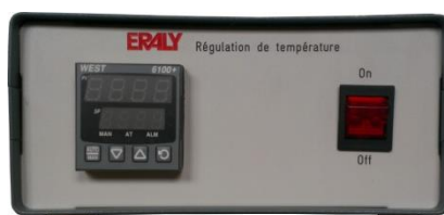
Régulateur programmeur de température monté dans un coffret
