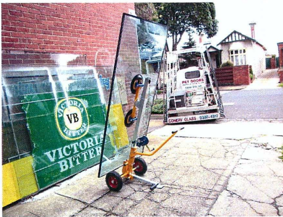
Démontable en 2 éléments de 20 kg pour le transport
