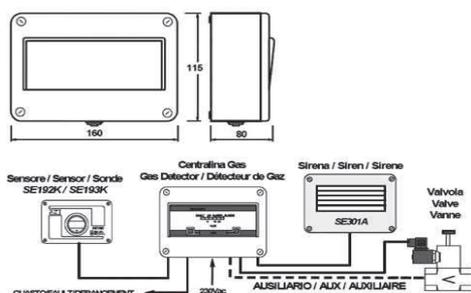
Centrale à microprocesseur analogique à sonde déportée pour installation sur rail DIN. Elle possède 2 seuils de détection de gaz et déclenche les 2 relais au dépassement des seuils d'alarme correspondants.
