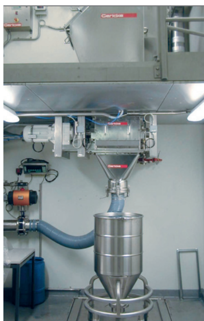
Vide-sac avec Nibleur équipé pour nettoyage en place
