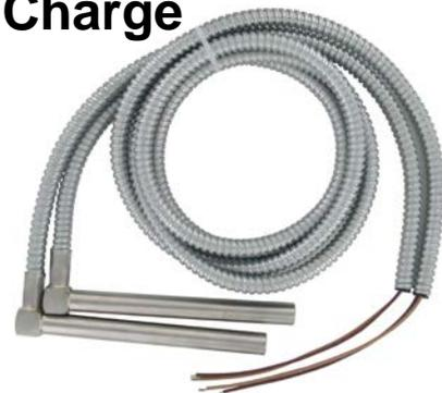
Les cartouches chauffantes haute charge sont des résistances électriques cylindriques dédiées au chauffage de solide ainsi que d'eau ou de gaz sous certaines conditions.
