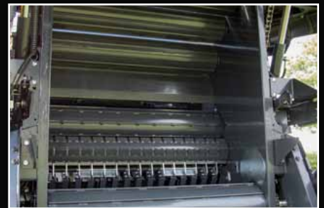
Chambre PowerMax : 17 rouleaux robustes pour des balles bien denses.
