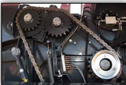
L'entraînement de la chambre principale se fait par chaîne 1" 1/4 renforcée pour une longévité accrue et un entretien réduit.
