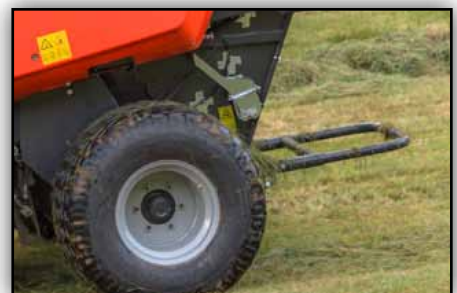
L'éjecteur en option permet de s'assurer que la balle roule hors de la porte arrière sans avoir à reculer après avoir réalisé chaque balle.
