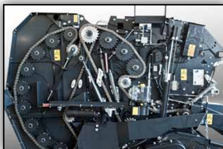
L'entraînement principal de la chambre se fait par chaîne 1" 1/4 renforcée pour une longévité accrue et un entretien réduit.
