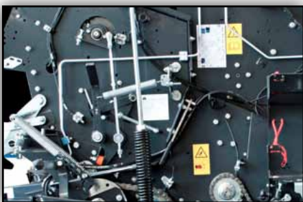
Tuyauterie hydraulique rigide.
