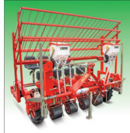
Microgranulatore per insetticida granulare, distribuzione in linea e trasmissione meccanica.
