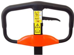
Préhension ergonomique en caoutchouc. Levier de manœuvre à trois positions pour levage, transport et abaissement.
