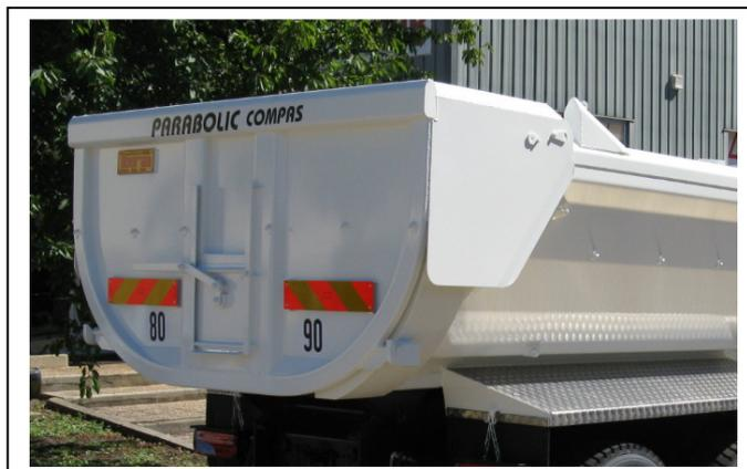
2 – **Vérins de porte hydrauliques protégés, fermeture type « guillotine »**
