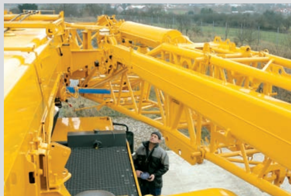
Dispositif auxiliaire hydraulique pour le montage de la fléchette pliante avec BTT
