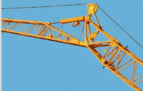
Fléchette pliante hydraulique réglable (0° - 40°)
