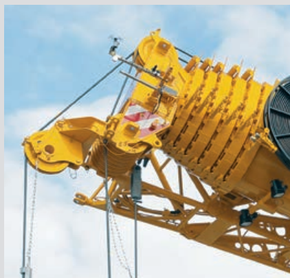
Poulie en extrémité de mât, rabattable sur le côté
