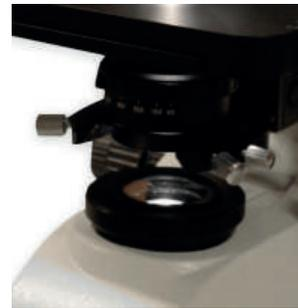
Système de traduction du plateau et réglage de la mise au point.
