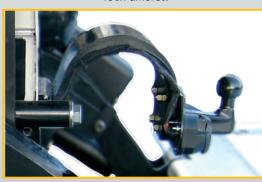
Console attache-remorque, montage rapide et facile, peut être posée après le montage du hayon.
