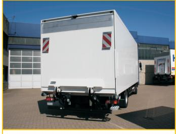
La solution pour tous les problèmes de charge utile : Le hayon élévateur standard X4A 1500 avec une capacité de 1.500 kg et un poids propre à partir de seulement 325 kg.
