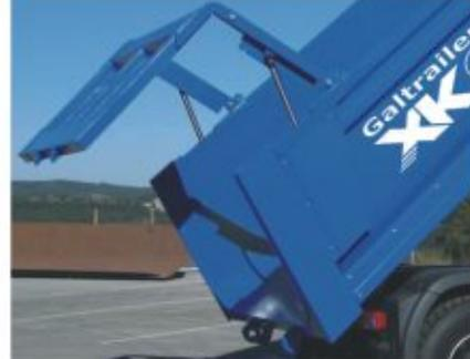
Support de roue de secours frontal et élévateur
