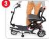
déplier le siège et verrouillez le mécanisme général en poussant le guidon vers l'avant et le dossier du siège vers l'arrière
