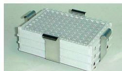
**Adaptateur pour plaques microtitre** de 85 x 130 mm, permet de superposer jusqu'à 3 plaques à la fois.
