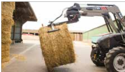
En déversant, la pince glisse par gravité avec la balle le long du mât vertical.
