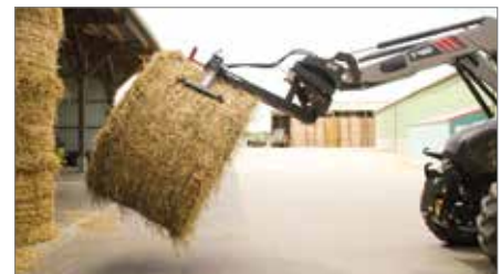
La pince se verrouille automatiquement en position haute.
