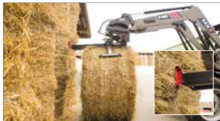
Pince en position basse, on appuie sur le poussoir pour déverrouiller la pince.
