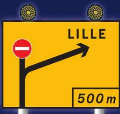
Les optiques sont placées au-dessus du signal.
