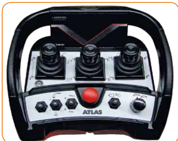
ATLAS J3 – mit 3 Kreuzhebel - with 3 cross levers
