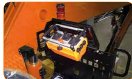
Nova XL – mit 3 Kreuzhebel - with 3 cross levers
