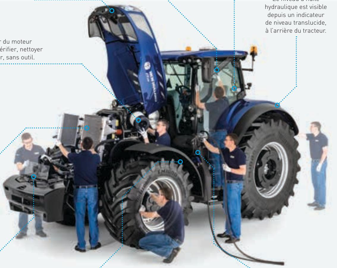
Le contrôle du niveau d'huile moteur et les orifices de remplissage sont faciles d'accès, sans nécessité de soulever le capot. Cela accélère les contrôles de routine.
