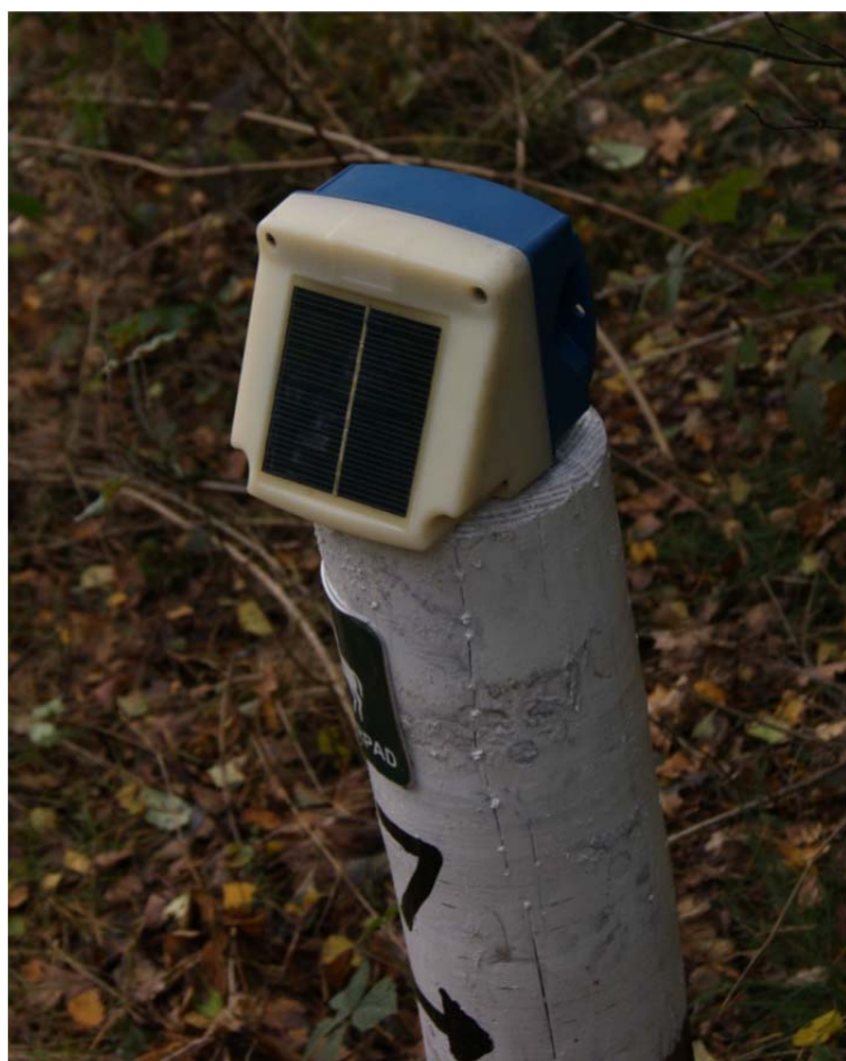
OMC-043-01 avec panneau solaire intégré, installée en tête de forage
