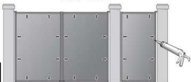
Protéger les points de jonction entre le soubassement et les cadres, ainsi que les points de fixation des barreaux.
