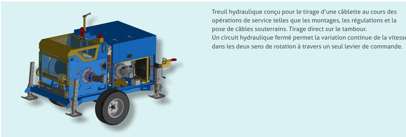
Treuil hydraulique conçu pour le tirage d'une câblette au cours des opérations de service telles que les montages, les régulations et la pose de câbles souterrains. Tirage direct sur le tambour. Un circuit hydraulique fermé permet la variation continue de la vitesse dans les deux sens de rotation à travers un seul levier de commande.
