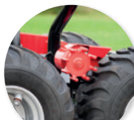
Assistance motrice par galets sur 14DP - 4WD
