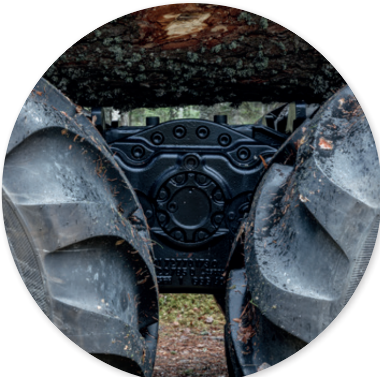
Pont moteur 40 km/h (débrayable)
