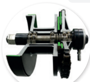
Vue d'un mécanisme de treuil en coupe
