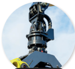
Flexibles dans le rotor sur séries 5 et 7
