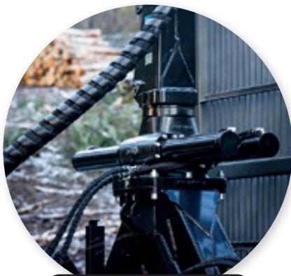
Bloc rotation moulé en fonte
