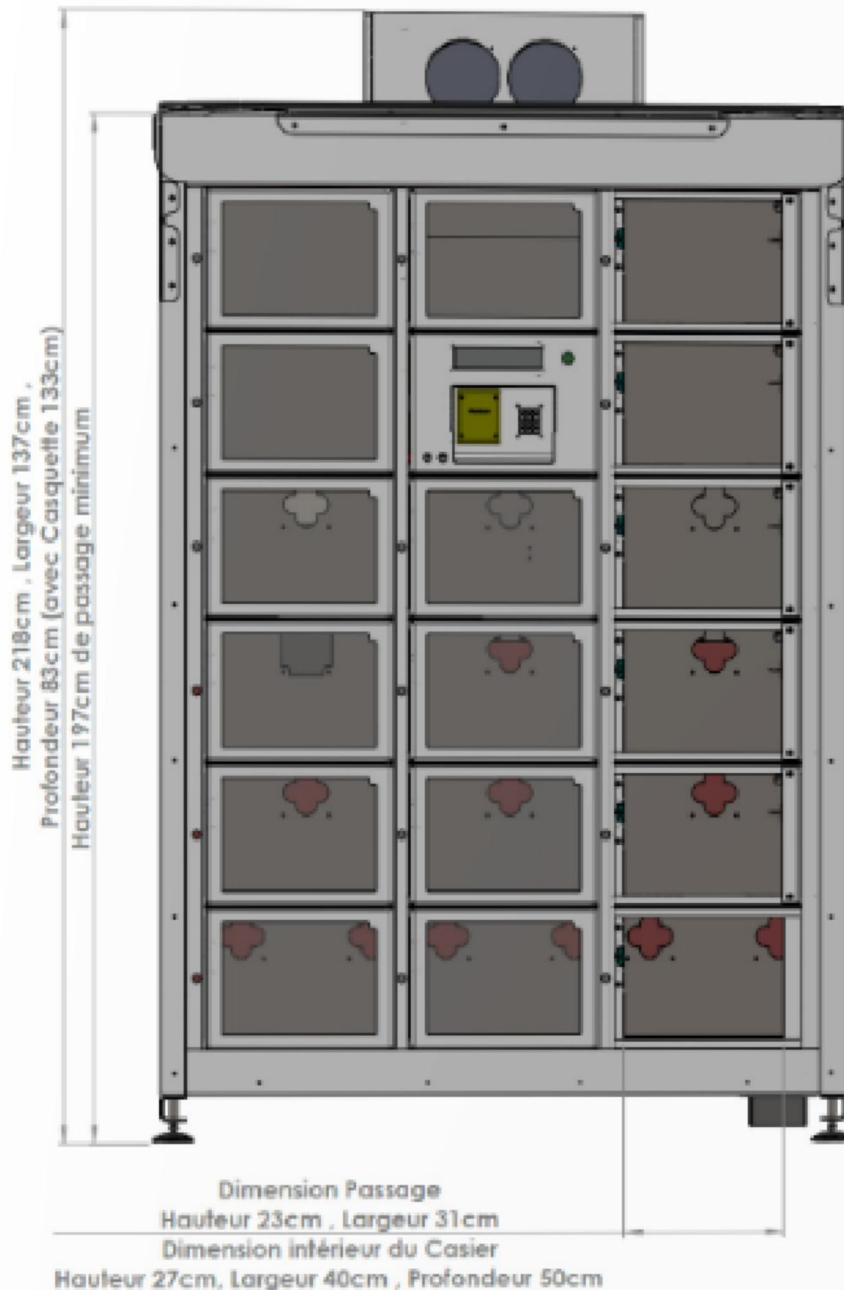
Le groupe-froid (en blanc sur la toiture) peut être démonté au moment de l'installation afin de passer le distributeur sous des chambranles de portes-bas)
