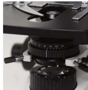
[5] Mécanisme de centrage du condenseur
