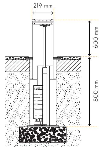
ÉPAISSEURS / Borne mobile : 4mm - Caisson d'encastrement : 4mm
